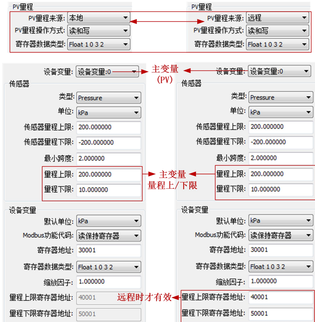
图 3.5 PV 量程操作实例
